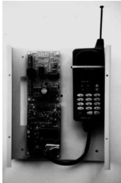
Monitorea la tensión y corriente de la línea telefónica detectando si la línea está cortada. Un contacto de relé informa al sistema de alarma la condición de falla de línea, de modo que pueda enviarse dicho evento a la central de monitoreo.
